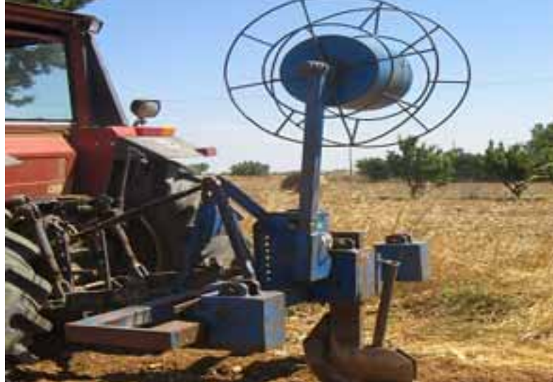
Foto 5: Attrezzatura per l'interramento delle ali gocciolanti
